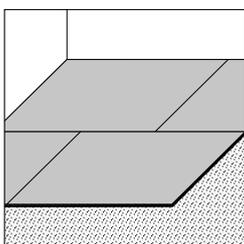
2 Verlegen PAVAFLOOR 5.4: Plattenoberseite = glatte Seite. Siebseite (rauhe Seite) nach unten. Verlegeart: englisch versetzt.
