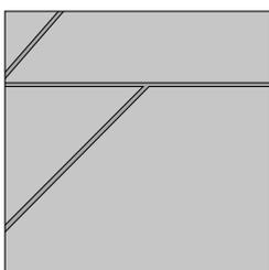
3 Stossfugen: Platten nur sanft aneinander stossen. Keine Press-, sondern minimale Dehnungsfugen vorsehen.
