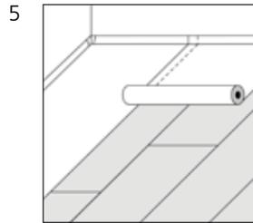
5 PAVAPOR Trittschall-dämmplatten/PAVABOARD je nach Einsatz mit Dampf- bremse/- sperre oder Feuchteschutz abdecken. Notwendigkeit vorgängig abklären.
