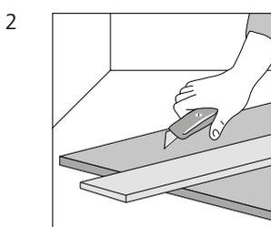
2 PAVASTEP mit Bodenlegemesser einfach und passgenau zuschneiden. Entlang von raumbegrenzenden Bauteilen Dilatationsfugen vorsehen (ca. 8 mm)
