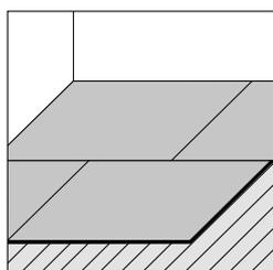
3 Verlegen PAVAFLOOR 5.4: Plattenoberseite = Siebseite (rauhe Seite). Verlegeart: englisch versetzt.
