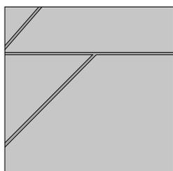
4 Stossfugen: Platten nur sanft aneinander stossen. Keine Press-, sondern minimale Dehnungsfugen vorsehen.
