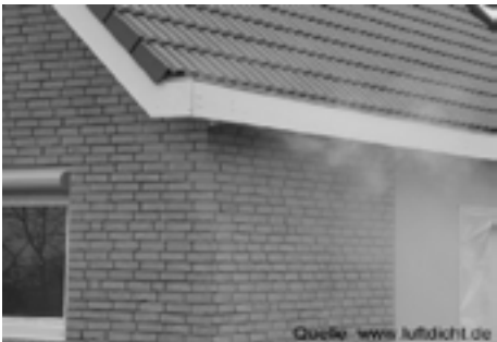
▶▶ Blower-Door-Prüfverfahren Variante B: mit Überdruck und Nebel zur Leckagesuche
