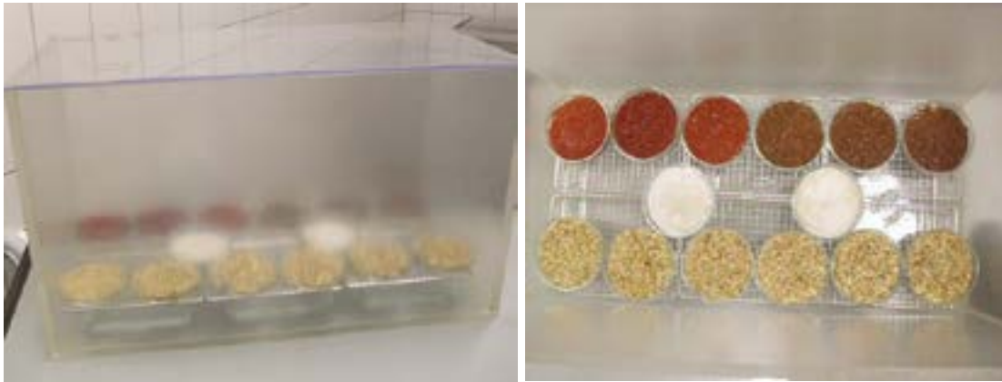
Abbildung 1: Anordnung der Prüfkörper in der feuchten Kammer Figure 1 configuration of test blocks in the moist chamber
