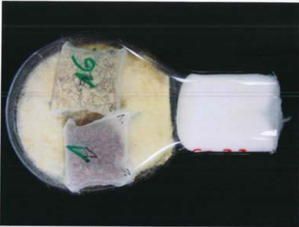
Bild 3: Proben auf Mycel von Coniophora puteana BAM Ebw. 15
