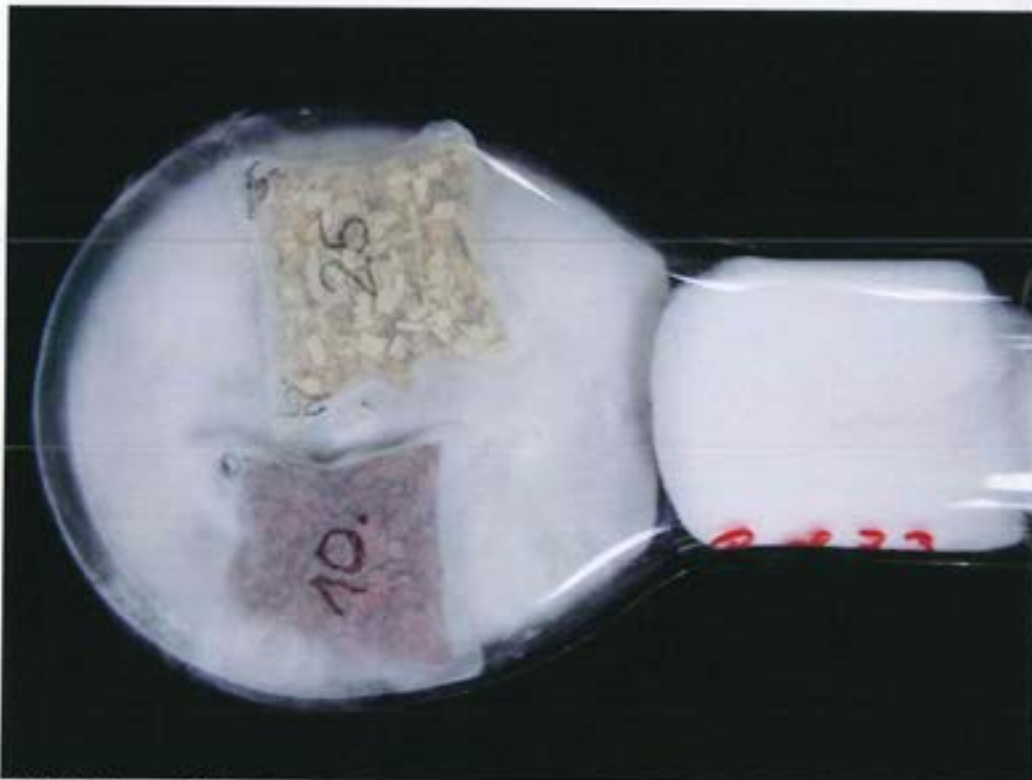
Bild 4: Proben auf Mycel von Poria placenta * FPRL 280
