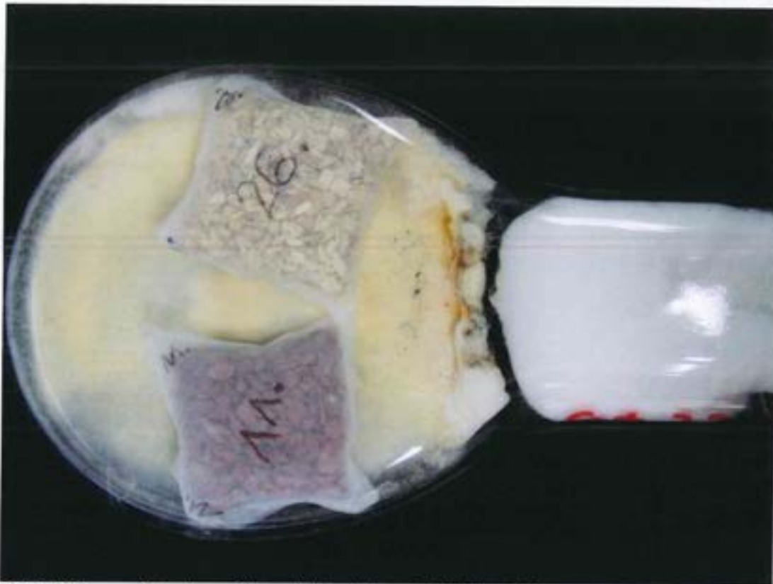
Bild 5: Proben auf Mycel von Gloeophyllum trabeum BAM Ebw. 109
