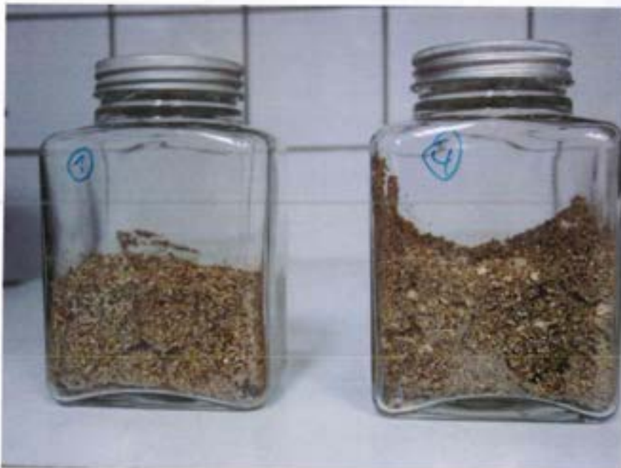
Abbildung: Versuchsaufbau - Vermiculitgemisch mit mineralisierter Holzspäne (links) und unbehandelte Kontrolle aus Vermiculit und unbehandelter Holzspäne (rechts). Tunnelbauten der Termiten sind gut zu erkennen.
