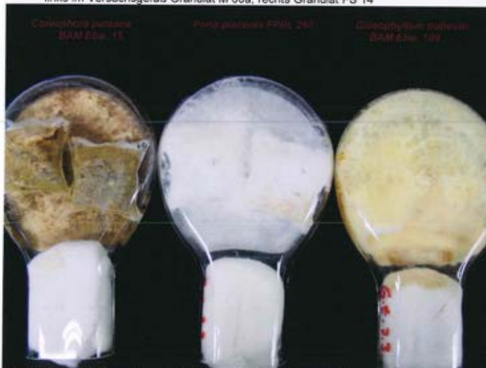
Bild 7: Proben vor dem Ausbau nach 16 Wochen im biologischen Versuch zur Prüfung der Virulenz der Prüfpilze mit Granulat FS
