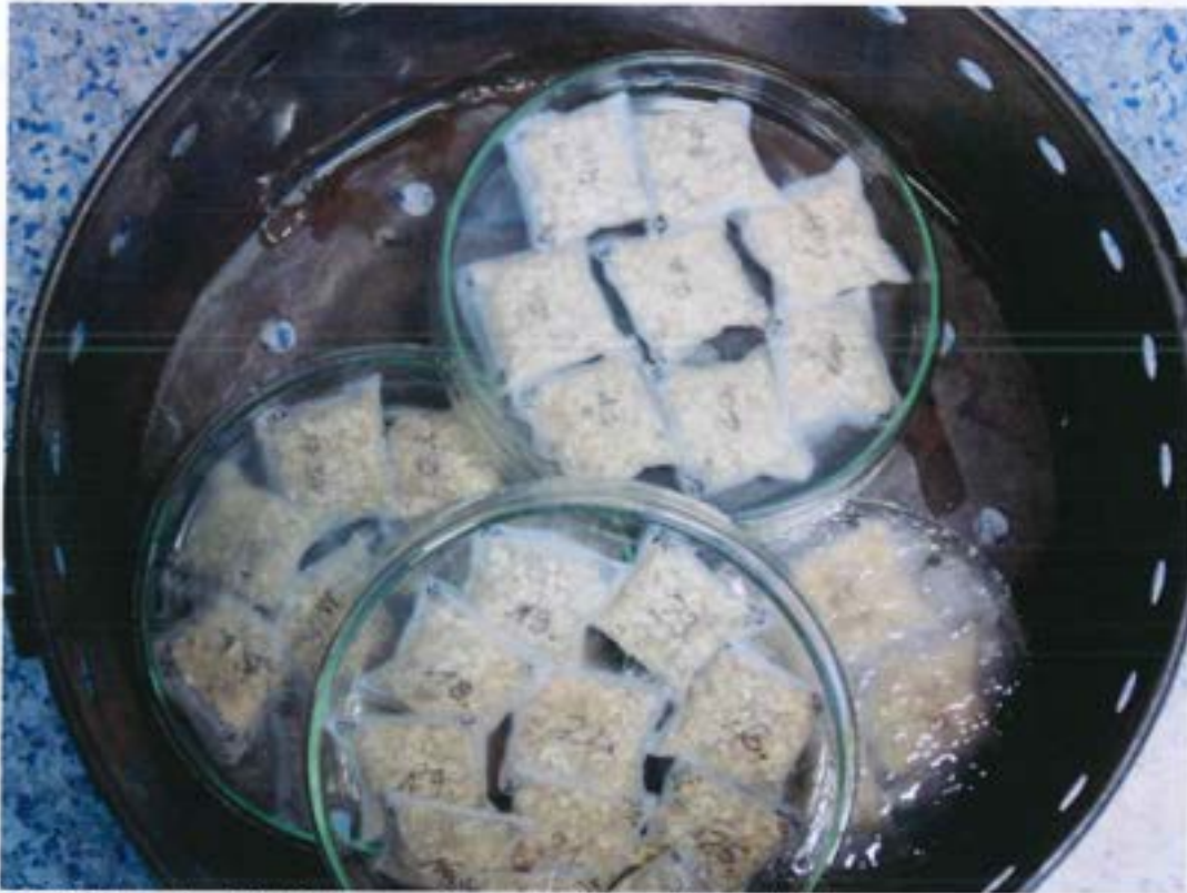
Bild 2: Eingeschweißte Proben von Granulat FS 14 vor der Sterilisation
