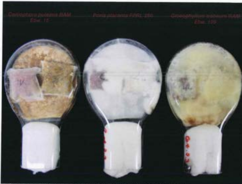
Bild 6: Proben vor Ausbau nach 16 Wochen im biologischen Versuch; links im Versuchsgefäß Granulat M 60a, rechts Granulat FS 14
