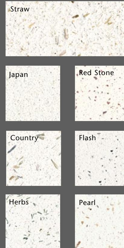
La texture di una superficie varia a seconda del metodo di lavorazione e degli ingredienti del materiale. Per arricchire le varianti di texture possibili, YOSIMA ha selezionato sette diversi additivi strutturali che creano molteplici effetti. Ognuno di loro può essere aggiunto a ciascuno dei 140 tonalità di colore proposte.
